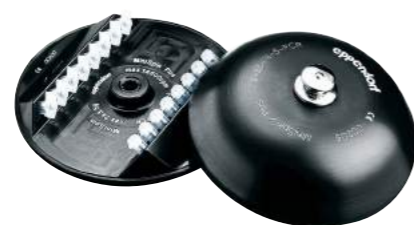
Rotor F-55-16-5 PCR > para tiras 2 x PCR
