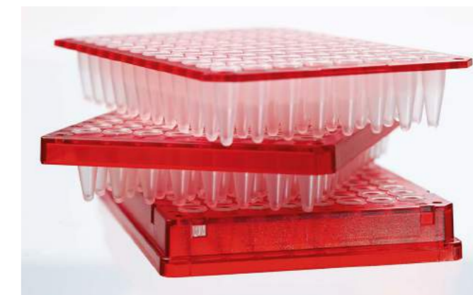
Diferentes formatos de moldura de placas Eppendorf twin.tec®: unskirted (cima), meio rebordo (centro) e skirted (baixo).
