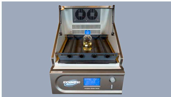
Soporte multiusos opcional: Plataforma independiente que fija rápidamente los recipientes entre varillas acolchadas ajustables (no requiere plataforma universal, varilla adicional disponible)
