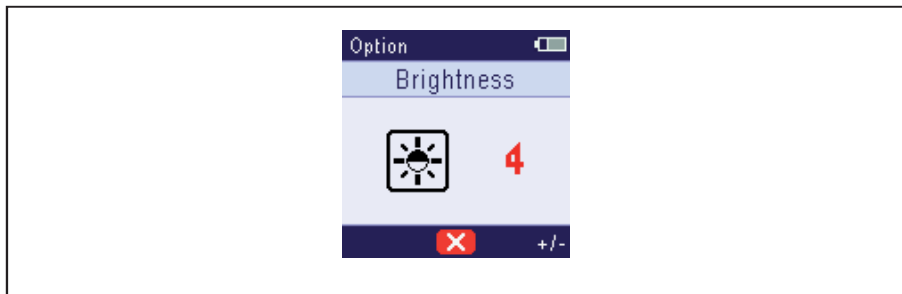
図 5-12: オプション 明るさ のモニター モニターの輝度は、8段階で設定できます。
