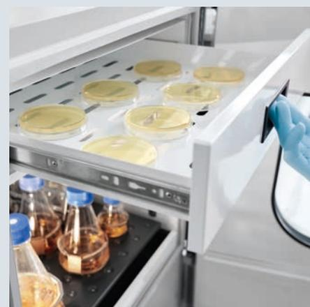
**Dessiccation des échantillons et protection contre l'évaporation du milieu :** le tiroir pour culture en option peut être utilisé pour protéger les plaques d'Agar de la dessiccation. Un bac de récupération intégré et un contrôle du taux d'humidité sont en option.
