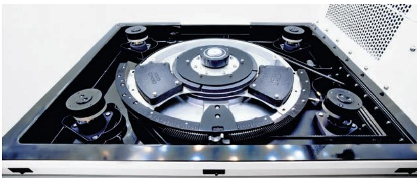
**L'Eppendorf X-Drive breveté, efficace pour longtemps :** avec ses cinq points de montage excentriques pour la plateforme de l'agitateur, l'entraînement est conçu avec précision pour garantir des performances durables et reproductibles avec des charges élevées pendant de nombreuses années. Les quatre arbres dans les coins et la technologie Balance Master permettent une agitation précise et sans vibrations en tout point de la plateforme, y compris la périphérie.
