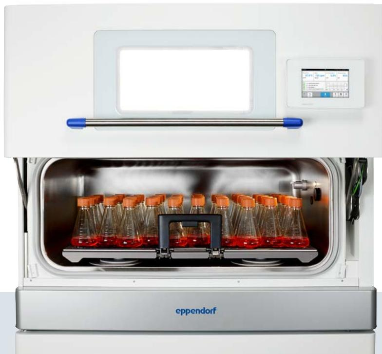
**Chambre en acier inoxydable :** conception hygiénique conforme à la norme EN ISO 14159:2008 avec peu de composants internes et pas de roue motrice, d'interstices, de plaques de protection, de câbles ou d'ailettes de chauffage à l'intérieur
