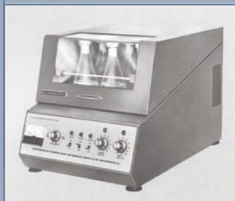
La série G, constituée des premiers agitateurs incubés, est mise au point. C'est la naissance du mécanisme d'entraînement triple excentrique, qui est toujours utilisé aujourd'hui. Pour la première fois, les scientifiques peuvent cultiver des cultures et des solutions microbiennes dans des conditions de température contrôlée et à des vitesses d'agitation élevées.
