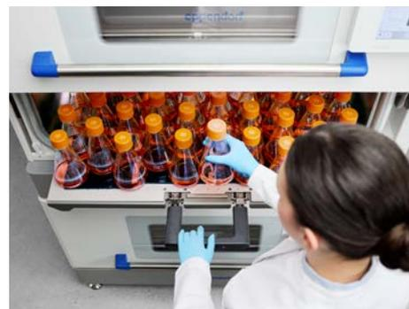
**Porte à ouverture vers le haut et plateforme coulissante** : gain de place. Facilite et accélère la préparation des expériences, le nettoyage et l'entretien, même dans le fond de la chambre.
