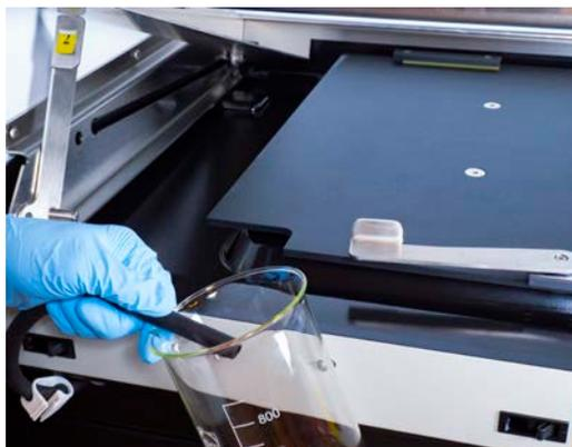
**Protection contre les éclaboussures et facilité de nettoyage** : l'entraînement Innova à triple excentrique est protégé des éclaboussures par un bac de récupération unique en son genre aux angles arrondis et drain. Le bac de récupération peut également être utilisé comme réservoir d'eau pour réduire l'évaporation du milieu.
