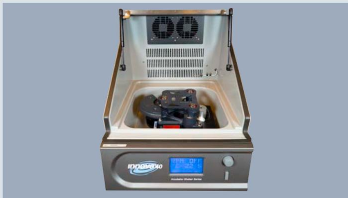
**Fiabilité 24/7 avec des charges élevées :** l'entraînement triple excentrique contrebalancé robuste (trois arbres supportant des poids, moteur robuste à courant continu sans balais) de l'Innova garantit un fonctionnement sans vibrations ni problèmes pendant des années.
