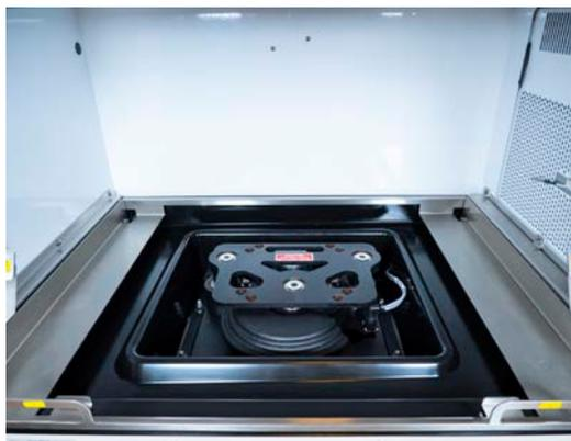
**Construit pour durer** : l'entraînement triple excentrique contrebalancé (trois arbres supportant des poids) de l'Innova garantit un fonctionnement sans vibrations ni problèmes avec des charges élevées pendant des années. Il ne faut pas confondre ici avec les entraînements « à triple contrepoids » qui ne comportent généralement qu'un seul support de poids.
