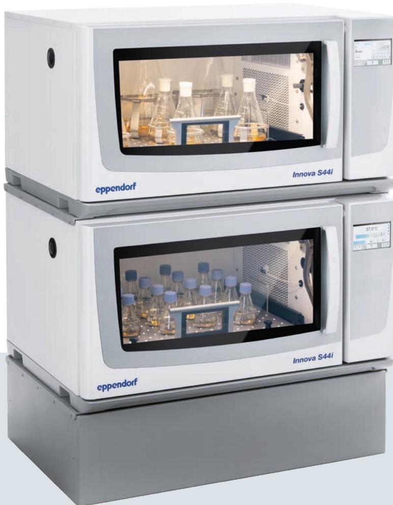
**Véritable contrôle avec l'interface tactile :** toutes les valeurs de consigne et actuelles sont visibles directement. La gestion des utilisateurs permet de limiter l'accès à la configuration des réglages
