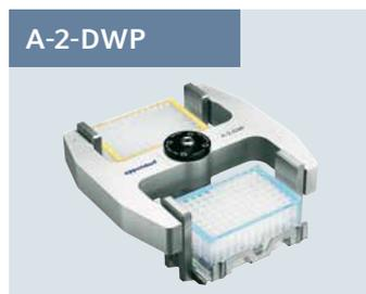
Rotor pour 2 plaques Deepwell pour plaques d'une hauteur max. de chargement de 89 mm. Vitesse max. :  $2\,250 \times g$  (3 750 rpm).
