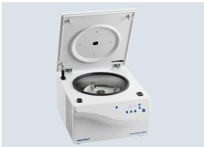
Centrifuge 5804 avec rotor pour plaques A-2-DWP
