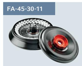
Rotor pour 30 microtubes 1,5/2 mL avec couvercle anti-aérosols pour la centrifugation sûre d'échantillons dangereux. Vitesse max. :  $20\,800 \times g$  (14 000 rpm).
