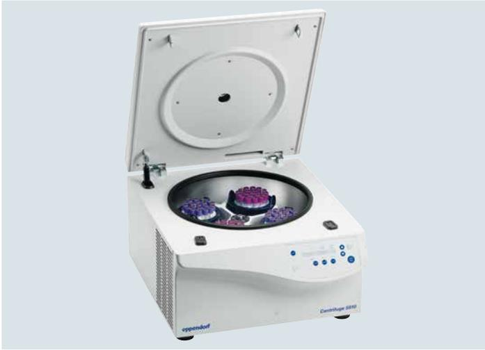
Centrifuge 5810 avec rotor S-4-104 (4 x 750 mL)
