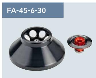
Rotor pour 6 x tubes coniques de 50 mL avec couvercle anti-aérosols QuickLock, pour tubes de 5 à 50 mL. Vitesse max.  $16\,639 \times g$  (11 000 rpm).
