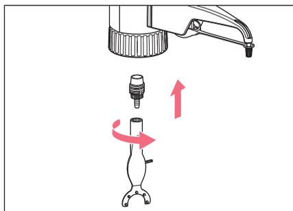
1. Visser la nouvelle vanne d'aspiration à la main dans le bloc de valves.
