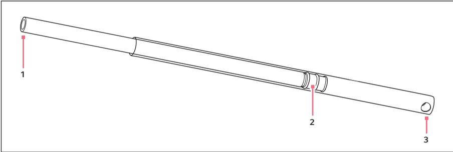
Fig. 3-3: Tuyau de puisage télescopique
