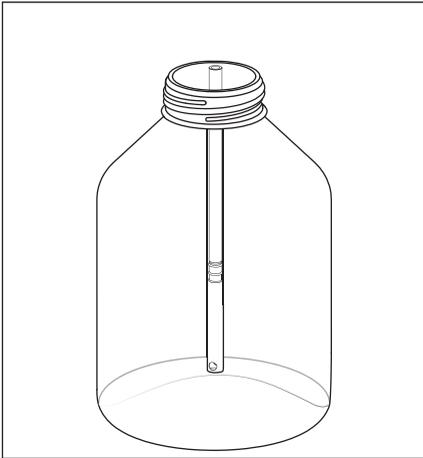
1. Tenir le tuyau d'aspiration télescopique à côté du flacon.
