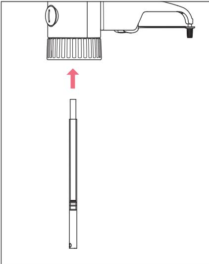
1. Glisser le tuyau d'aspiration télescopique en ligne droite dans la vanne d'aspiration jusqu'en butée.
