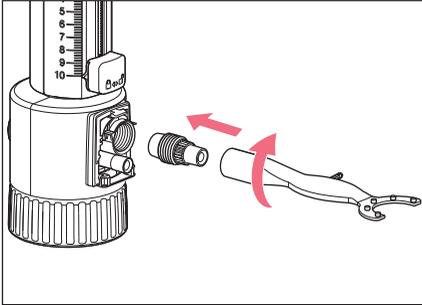
1. Visser la nouvelle soupape de sortie à la main dans le bloc de valves.
