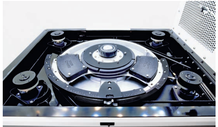
Eppendorf X-Drive für Innova S44i- und CellXpert CS220-Modelle
