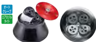
R9A2 (CR30NX/CR22N専用) 1,500mL×4本、8,500rpm/15,100×g、 質量 17.1kg ¥2,220,000
