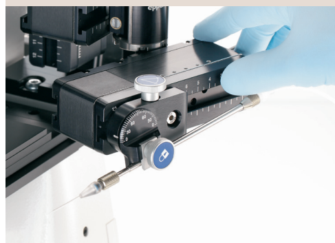
キャピラリー交換を容易にするスイベルアウト機能
