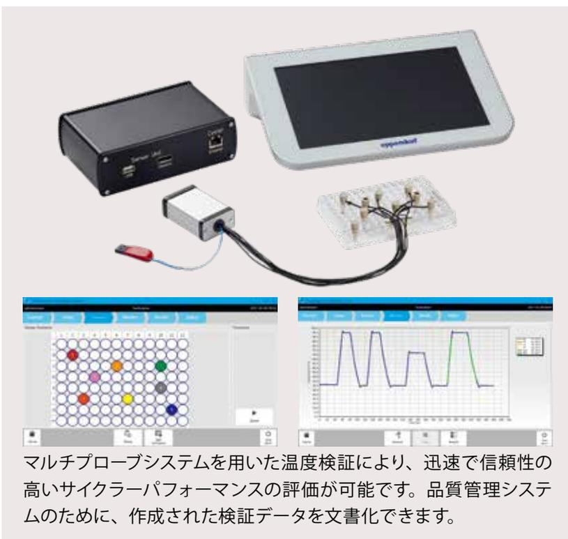
マルチプローブシステムを用いた温度検証により、迅速で信頼性の高いサイクラーパフォーマンスの評価が可能です。品質管理システムのために、作成された検証データを文書化できます。
