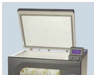
本体上面が開閉するので、フラスコのアクセスが容易です。
