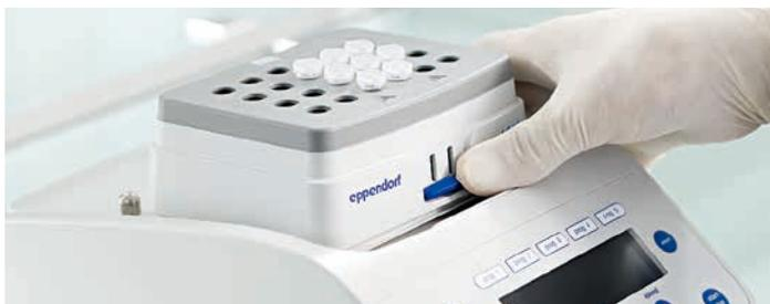
すべてのEppendorf SmartBlocksには、ユニークなEppendorf QuickRelease™ システムが搭載されているため、すばやく簡単にブロック交換を行うことができます。
