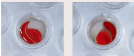
ミックスメイトによるミキシングのタイムラプス写真。エッペンドルフ ツインテック PCR プレート 96 に着色した水を入れ、1,650 rpm でミキシングして撮影しました。
