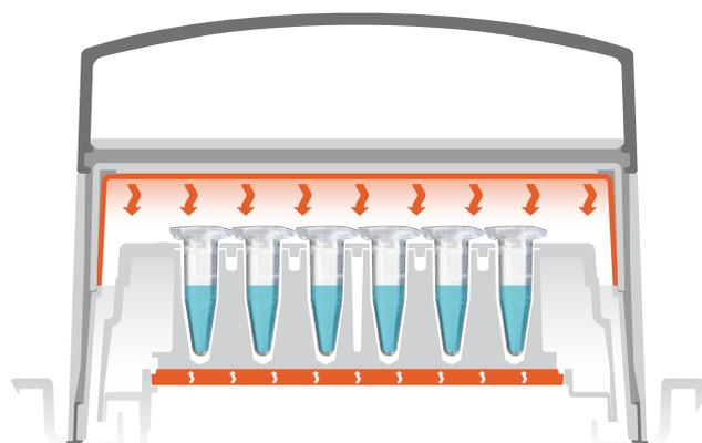
サーモトップを本体に置くと、すぐに加熱が始まります。サンプルに悪影響が出ないようにサーモトップの温度は設定温度に合わせて最適に調整されます。結露による水滴が発生することはありません。
